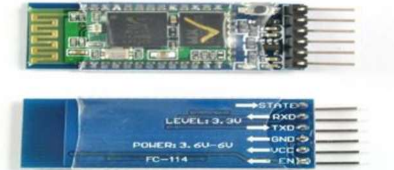
Fig: 3: HC05 Bluetooth module
